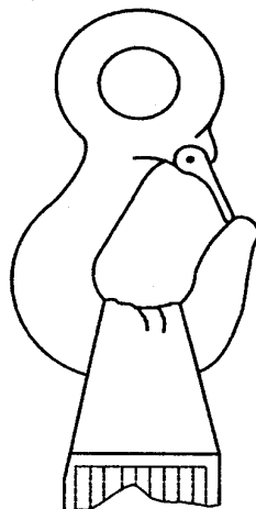
28 Pav. Netinkamo ausinės juostos kilpos suderinamumo su pernelyg mažo diametro kabliu iliustracija
